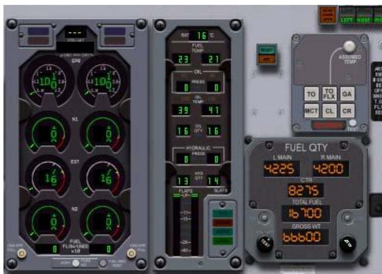
Il se compose de 3 parties : les manomètres de paramètres moteurs, le FUEL QTY (Emport de carburant) et le TRC (Thrust Rating Computer), les 6 petits blancs.
