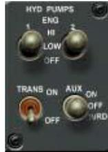
Appuyez à nouveau sur F2, actionnez les reverses. Ils nous serviront de cobayes pour le test. Normalement, seules les lumières jaunes s'allument et le message suivant apparaît sur l'EOAP « L & R REVERSE ACC LOW ». Un autre message doit être lisible « L & R HYD PRESS LOW ».
